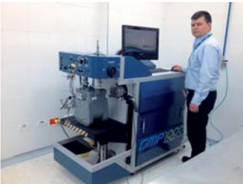
Figura 4. Gas Meter Prover GMP1000 Fuente: Corporación CDT de GAS
