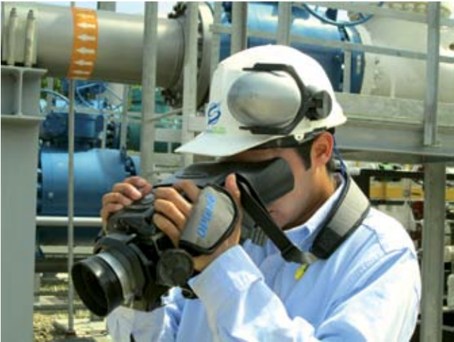
Figura 1. Detección y Medición de Fugas con cámara Infrarroja y muestreador de alto caudal.
