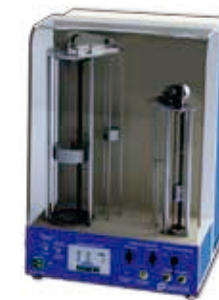
Figura 6. PATRÓN TIPO PISTÓN Fuente: Corporación CDT de GAS
