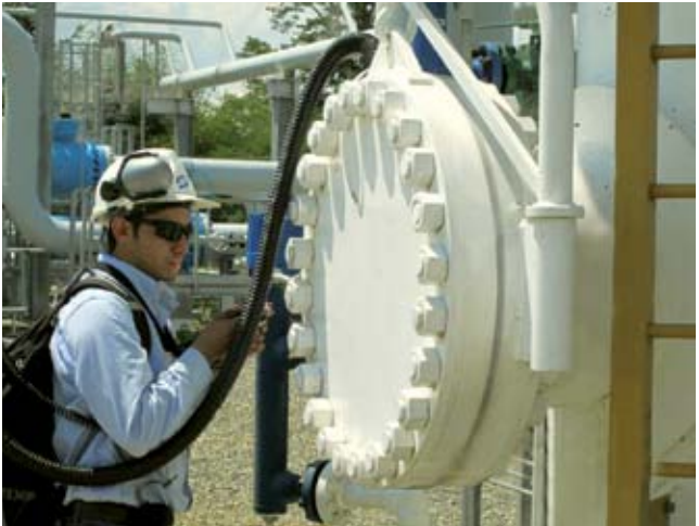
Figura 1. Detección y Medición de Fugas con cámara Infrarroja y muestreador de alto caudal.
