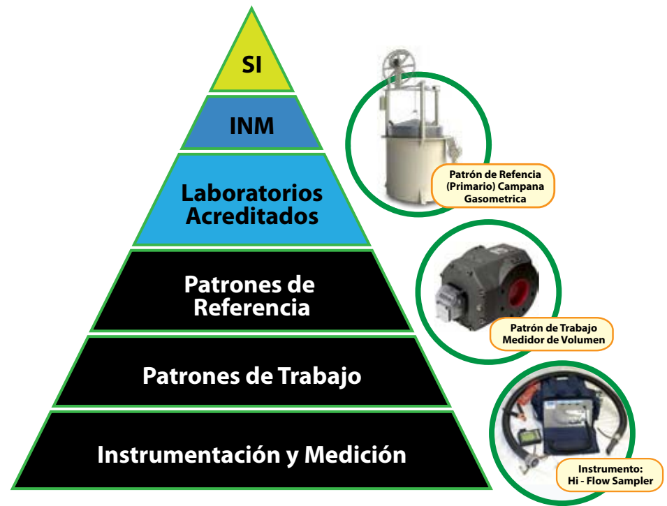
Figura 2. Esquema de Trazabilidad.
