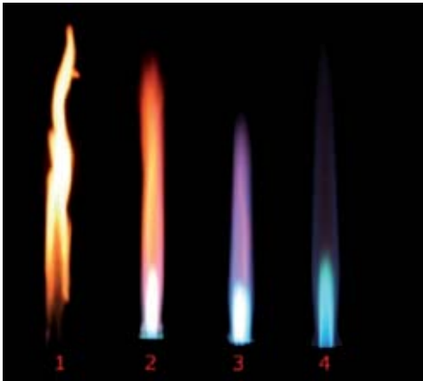
Figura 2. Tipos de llama en un mechero Bunsen dependiendo del flujo de aire. 1. Válvula de aire cerrada. 2. Válvula medio cerrada. 3. Válvula semi-abierta. 4. Válvula abierta al máximo 5 .
