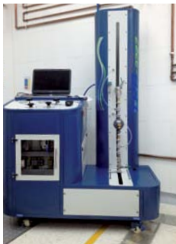
Figura 3. Test Regulators Bench TRB-3727 Fuente: Corporación CDT de GAS
