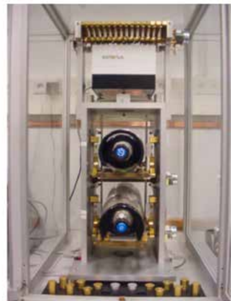
Figura 3. Balanzas de un solo plato del laboratorio Van Swinden Laboratory (VSL), de Países Bajos
