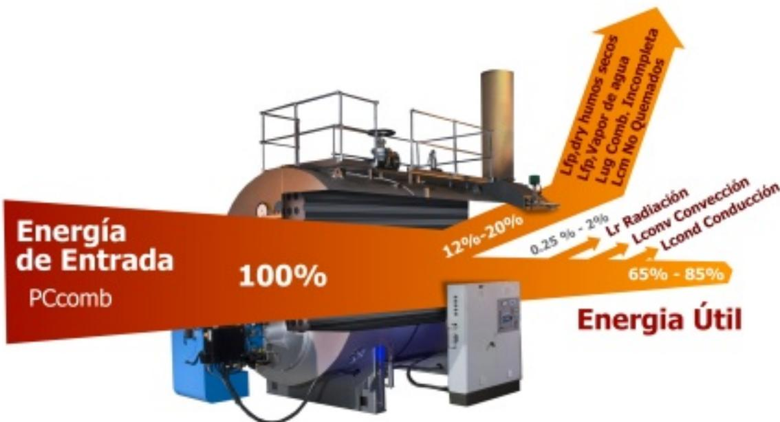
Figura 1. Diagrama Sankey Típico para un Generador de Vapor
