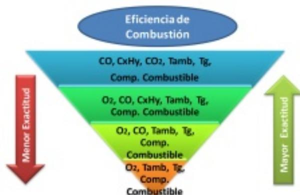
Figura 2. Mediciones y Exactitud<sup>3</sup> en la eficiencia de Combustión
