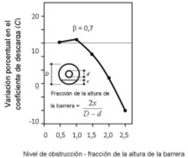
Figura 2. Efecto de la acumulación de líquido en el tubo de medición.
