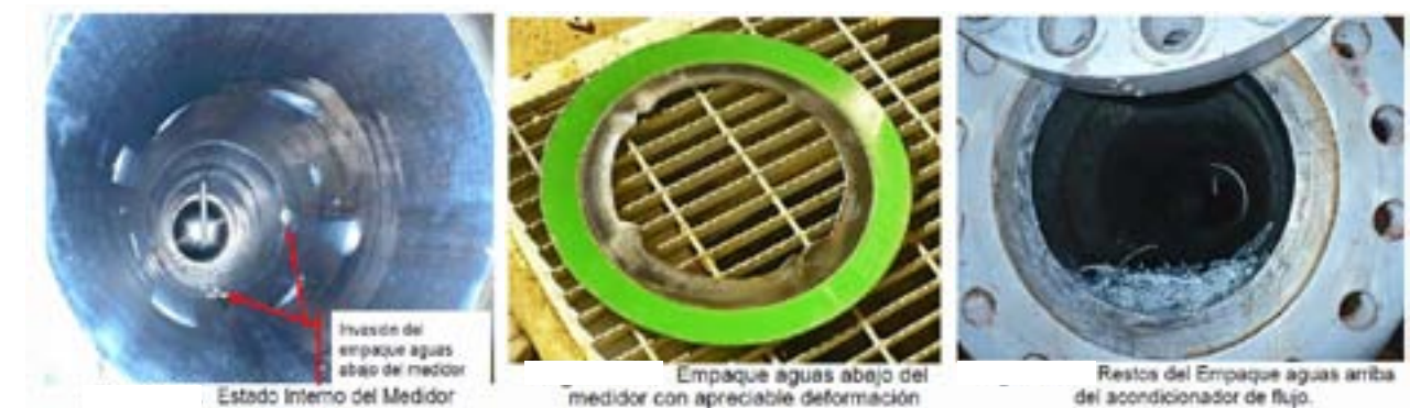
Figura 7. Evidencia y corrección de anomalías detectadas en los programas de mantenimiento del Sistema de Medición.
