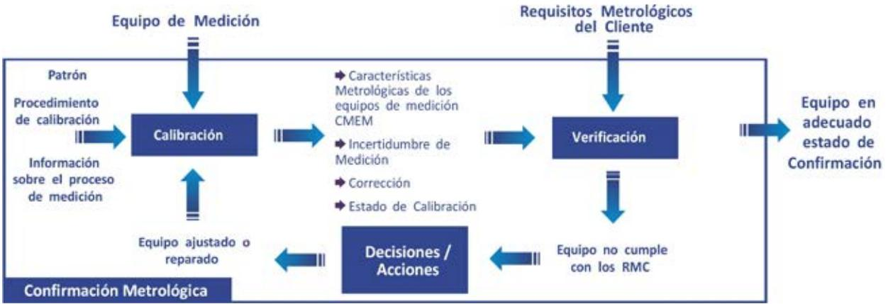
Figura 1. Proceso de Confirmación Metrológica
