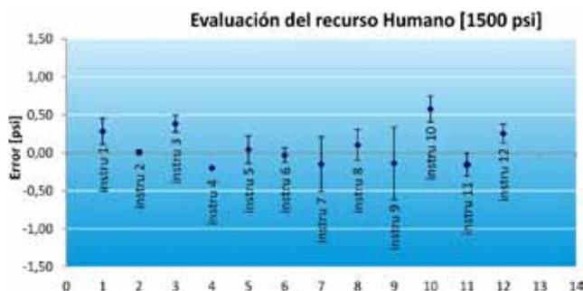
Figura 10. Resultados de pruebas de recurso humano en calibraciones de presión a 1500 psi.
